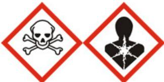
**Предупреждающее слово/Маркировка:** **ОПАСНО!** Жидкость и пары обладают чрезвычайной огнеопасностью. Смертельно при попадании внутрь. Вещество способно оказывать пагубное воздействие на репродуктивную функцию и на плод (фетотоксичный и тератогенный эффекты).
